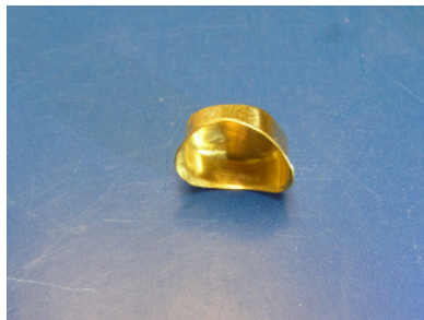
Sekundärteil – Oberfläche der Innenseite mit HM SILBERGALVA hergestellt
