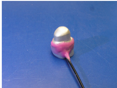
Abdecken aller nicht zu galvanisierenden Teile mit Galvano-Wachs
